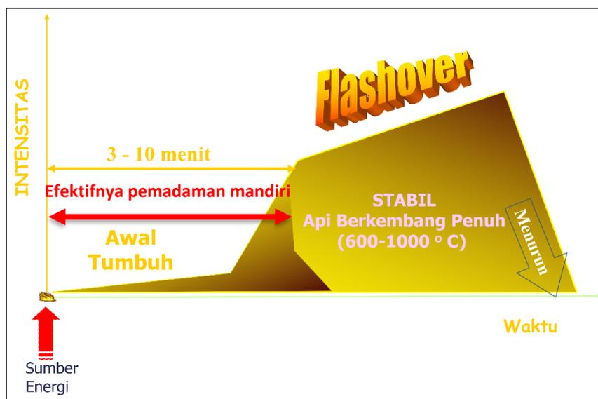
Gambar 6. Diagram titik poin efektifitas pemadaman mandiri
