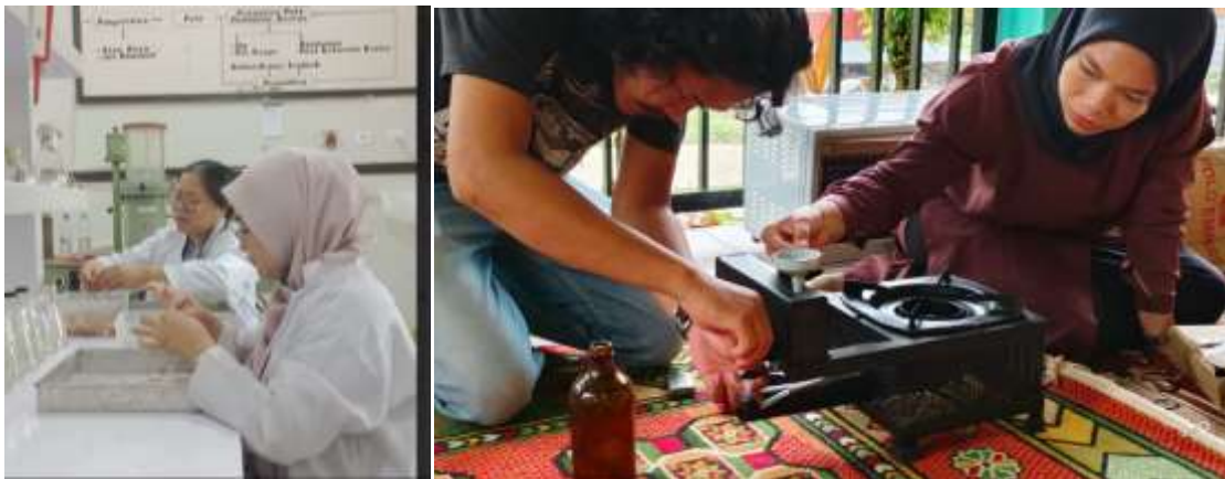
Gambar 2. Pengujian Lanjutan Produk Biodiesel Di Laboratorium Dan Uji Nyala Kompor Biodiesel
