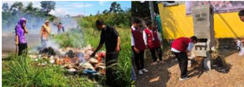
Gambar 12. Perbandingan Pembakaran Sampah secara Konvensional di Pinggir Jalan dan Pembakaran Sampah Menggunakan Rocket Stove
